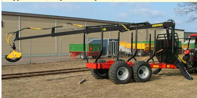
Skogsekipage 14 ton, byggd för stora kranar, dubbelram, ramstyrning, lång lastyta, boggie, lavettstödben, snabbkopplad kran, 2-spaks ventilpaket, 500/45x22,5
