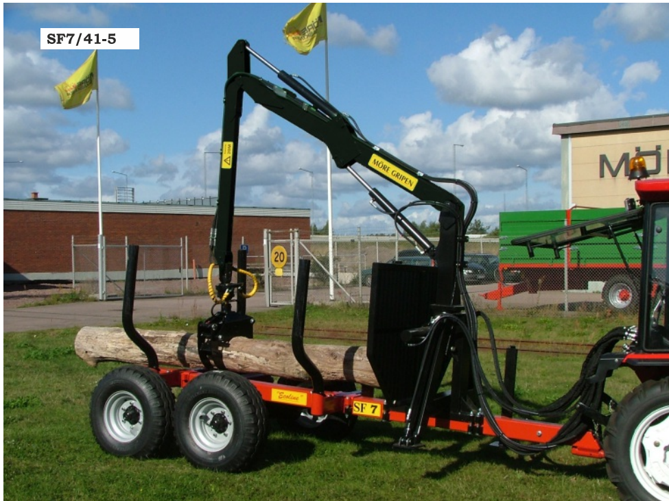
Forstanhänger 7 Tonnen, Zentralrahmen, Tandembereifung, hydraulische Stützfüße, schwenkbare Rungen, Zugdeichsel für Traktor
