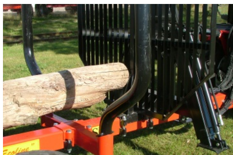
Forstanhänger 7 Tonnen, Zentralrahmen, Tandembereifung, hydraulische Stützfüße, schwenkbare Rungen, Zugdeichsel für Traktor
