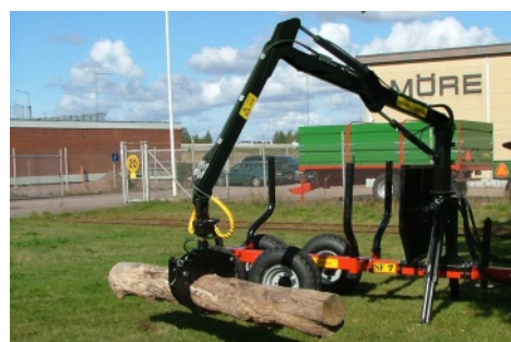
Forstanhänger 7 Tonnen, Zentralrahmen, Tandembereifung, hydraulische Stützfüße, schwenkbare Rungen, Zugdeichsel für Traktor
