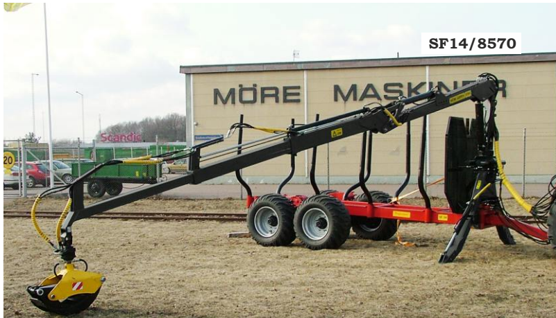
Forstanhänger 14 Tonnen, für große Kräne geeignet, Knicklenkung, lange Ladefläche, Tandemachse, Flap-Down-Stützen, leicht anzuschließender Kran, 500x45x22,5
