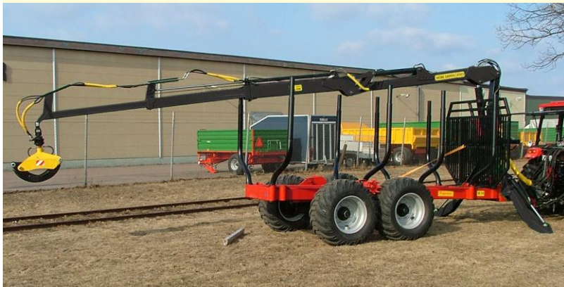
Forstanhänger 14 Tonnen, für große Kräne geeignet, Knicklenkung, lange Ladefläche, Tandemachse, Flap-Down-Stützen, leicht anzuschließender Kran, 500x45x22,5
